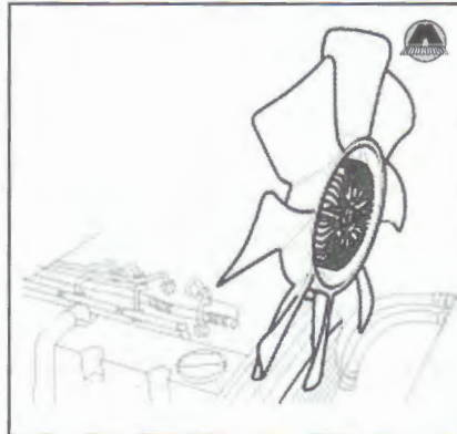
23. Установить вентилятор и шкив привода насоса системы охлаждения (А).
