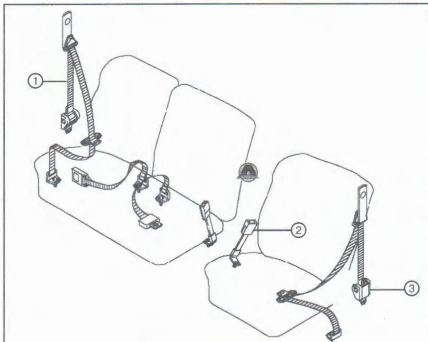
1. Ремень безопасности 2. Ответная скоба ремня безопасности 3. Механизм возврата ремня безопасности
