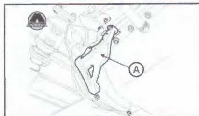
12. Снять опоры коробки передач (А) и (В).
