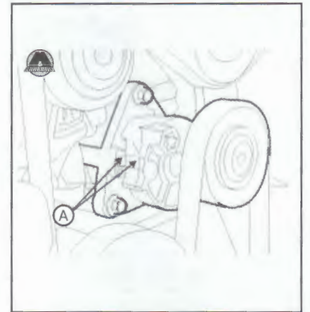
26. Установить кожух вентилятора (А), завернуть болты крепления.
