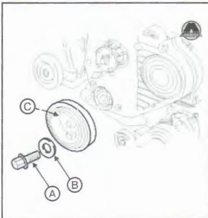
21. Завинтить крепежный болт (А), установив шайбу (В) и шкив коленчатого вала (С).
